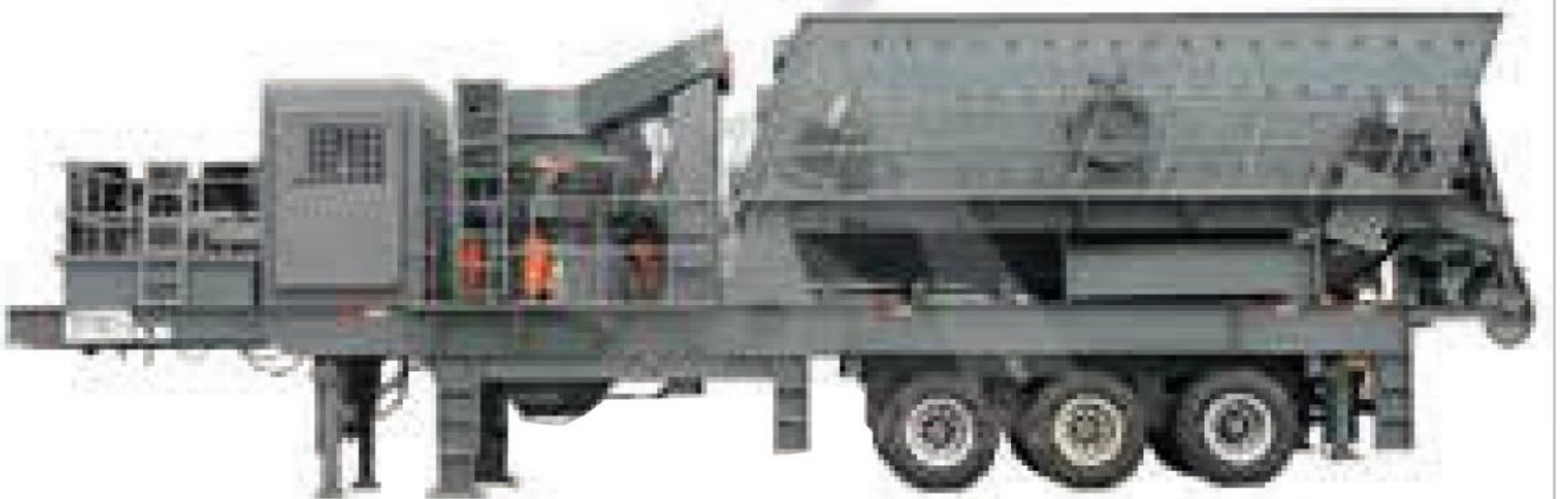
STATION DE CONCASSEUR DE GRANULATS MOBILE À ROUES MOBILES
