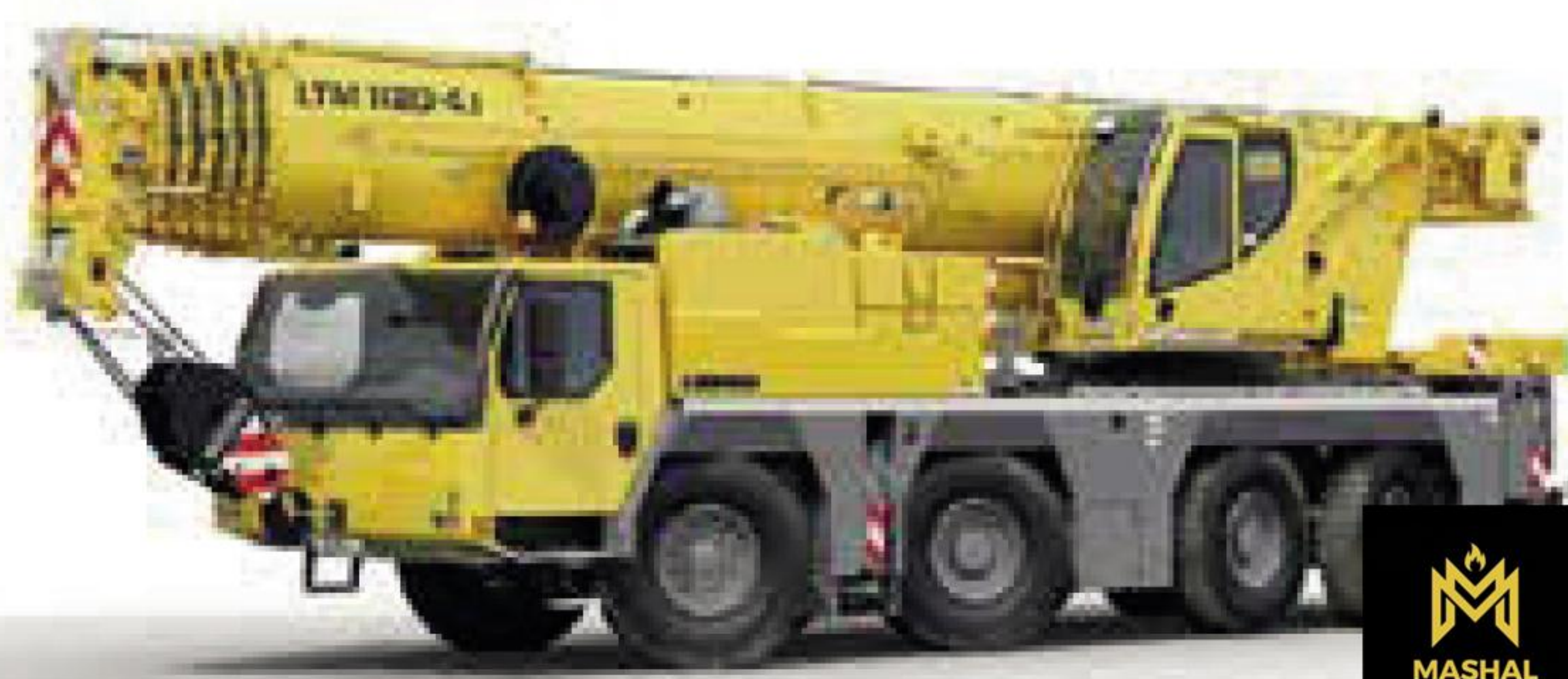
CAMION GRUES MOBILE 160 TONNES
